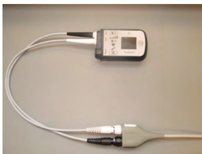
Rysunek 3.55 Przewody zasilania urządzenia sterującego systemem podłączone do złączy przewodu pacjenta zasilacza przenośnego
