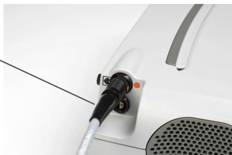
Rysunek 3.69 Pociąganie za czarną część złącza redukującą naprężenia w celu sprawdzenia połączenia
