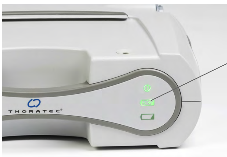
Rysunek 3.27 Zielony symbol ładowania (bateria zapasowa modułu zasilania jest naładowana)
