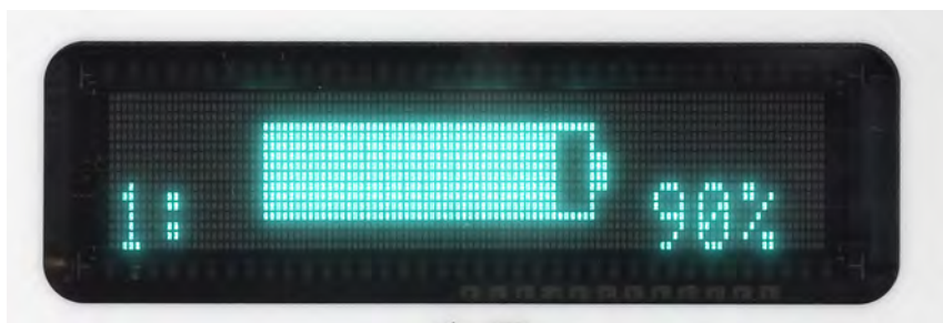
Rysunek 3.82 Poziom naładowania baterii wyświetlany na ładowarce baterii (bateria naładowana w 90%)
