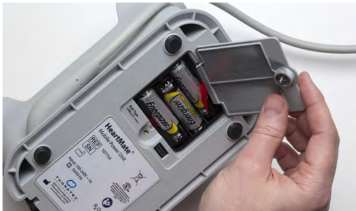
Rysunek 3.45 Zdejmowanie pokrywy kasety baterii
