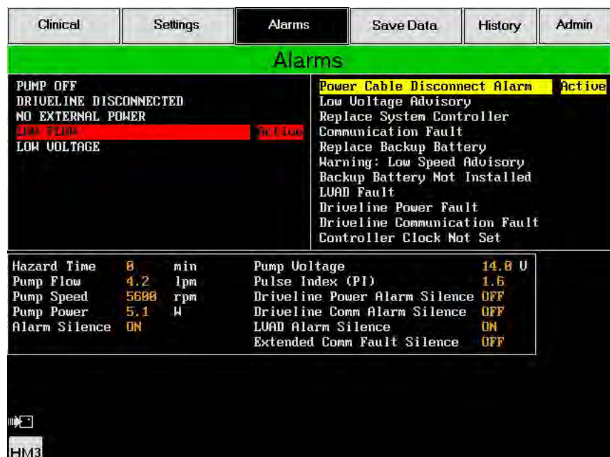
Rysunek 4.28 Ekran Alarms (Alarmy) z wieloma aktywnymi alarmami
