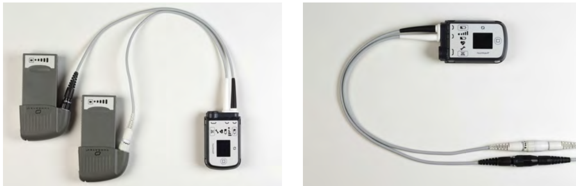
Rysunek 2.21 Urządzenie sterujące systemem w trybie ładowania na zasilaniu z baterii (z lewej) oraz z modułu zasilania (z prawej)
