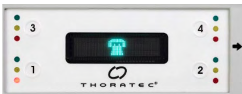
Rysunek 7.6 Wyświetlacz informacyjny w trybie wyświetlania symboli graficznych. Należy zwrócić uwagę na czerwoną kontrolkę gniazda 1.
