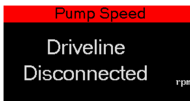
Rysunek 4.13 Komunikat Driveline Disconnected (Napęd odłączony)
