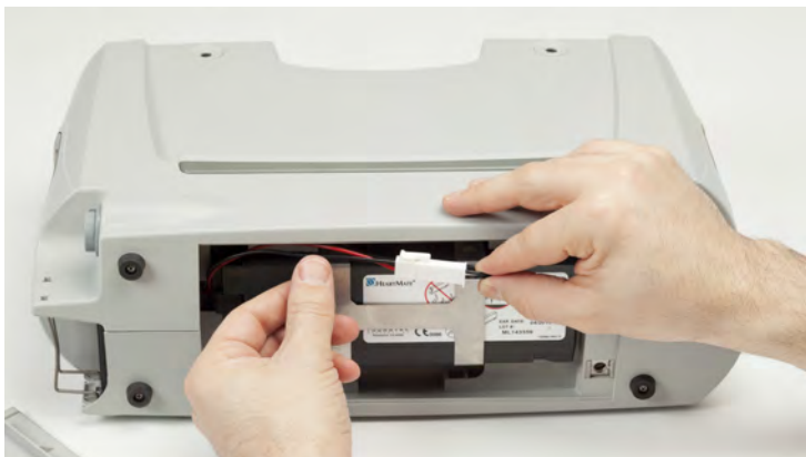
Rysunek 3.33 Ostrożne zdejmowanie przewodów i złączy z baterii
