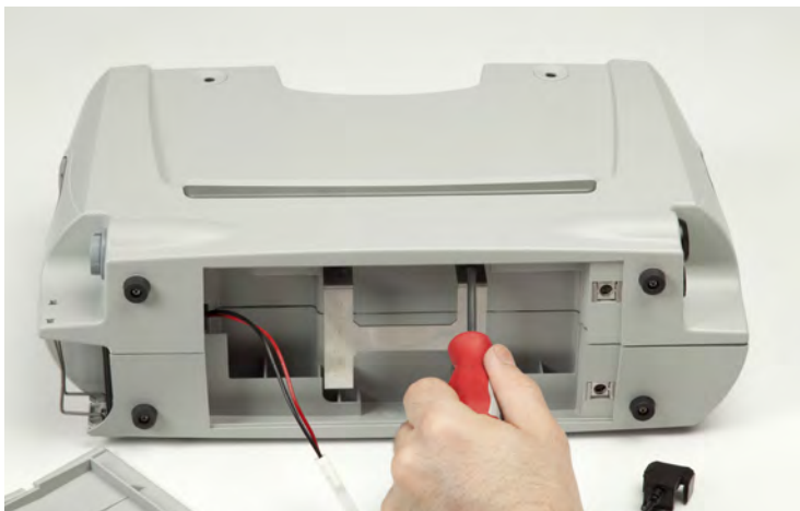
Rysunek 3.7 Usuwanie metalowego uchwytu
