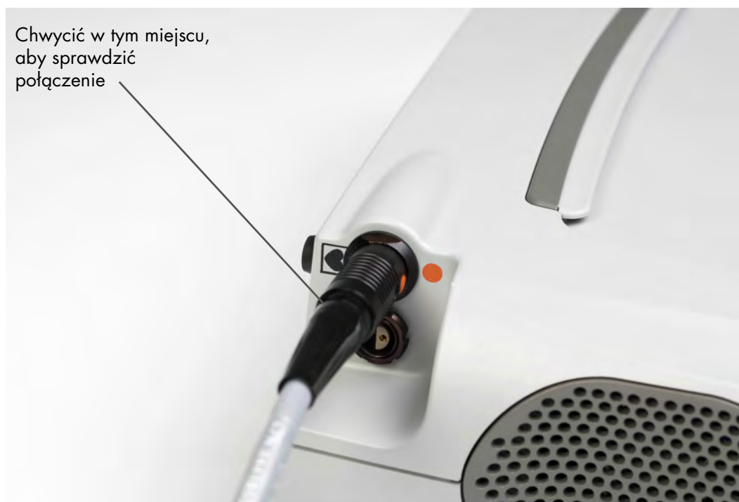
Rysunek 3.18 Pociąganie za czarną część złącza redukującą napięcie w celu sprawdzenia połączenia
