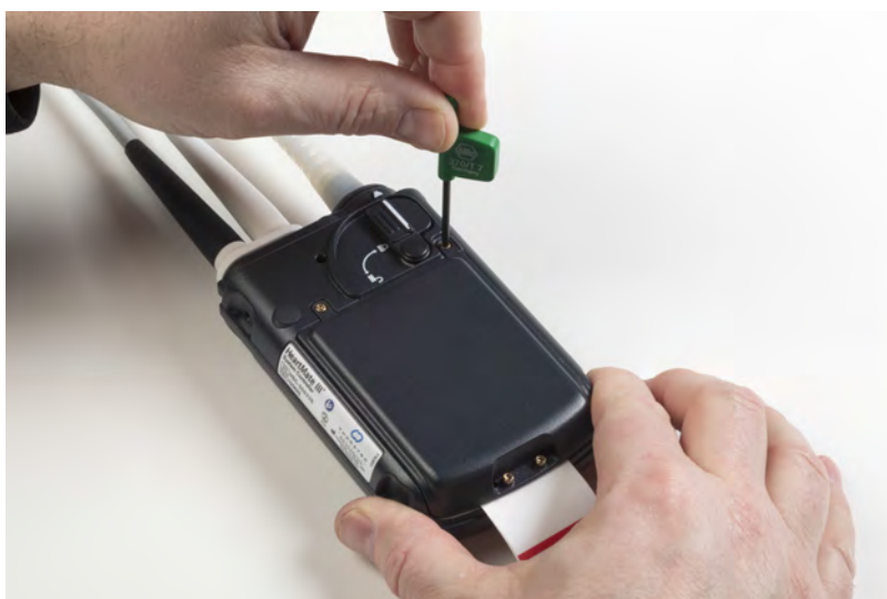
Rysunek 5.42 Poluzowywanie śrub
