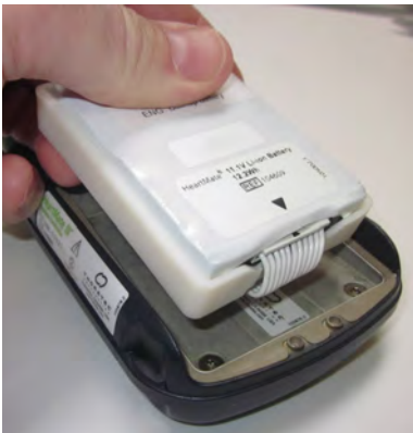
Rysunek 5.44 Umieszczanie baterii we wnętrzu kasety baterii
