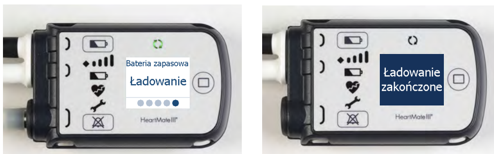
Rysunek 2.35 Komunikaty na urządzeniu sterującym systemem: „ładowanie” oraz „ładowanie zakończone”
