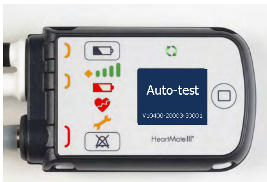
Rysunek 2.17 Interfejs użytkownika podczas autotestu urządzenia sterującego systemem
