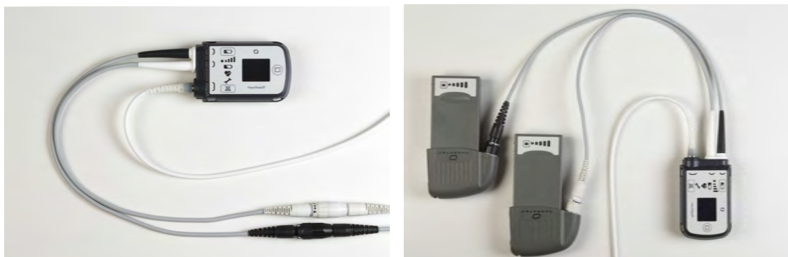
Rysunek 2.34 Urządzenie sterujące systemem zasilane z modułu zasilania (z lewej) oraz z baterii (z prawej)
