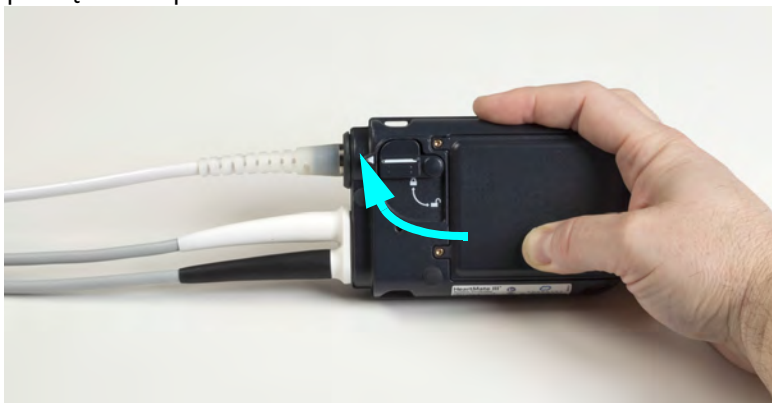
Rysunek 2.12 Podłączanie i blokowanie napędu w gnieździe
