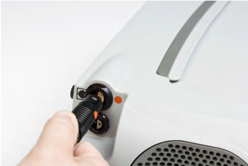
Rysunek 3.22 Ustawienie czerwonej kropki na złączu w jednej linii z czerwoną kropką na module zasilania
