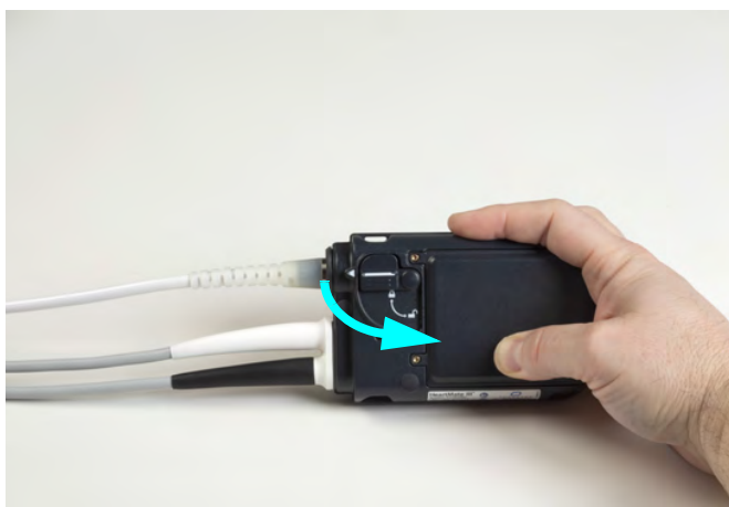
Rysunek 2.13 Odblokowywanie blokady bezpieczeństwa
