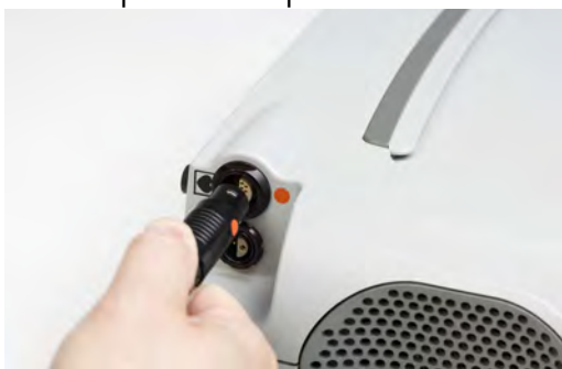
Rysunek 3.68 Ustawienie czerwonych kropek w jednej linii
