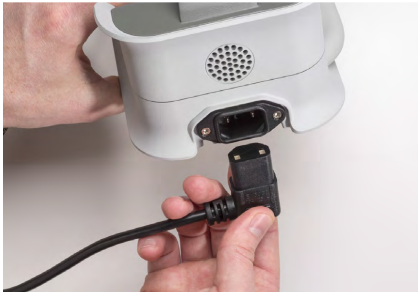
Rysunek 3.48 Podłączanie przewodu zasilania do zasilacza przenośnego
