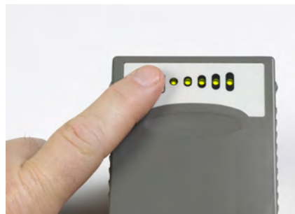
Rysunek 3.61 Wskaźnik poziomu naładowania baterii znajdujący się na baterii i naciskanie symbolu baterii w celu aktywowania słupków
