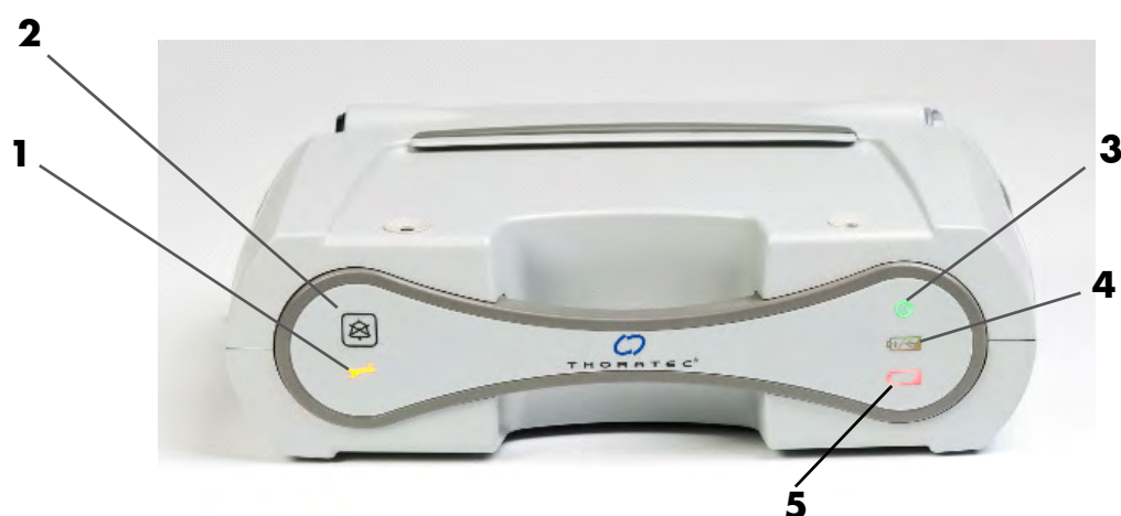
Rysunek 7.4 Kontrolki alarmowe na panelu czołowym modułu zasilania
