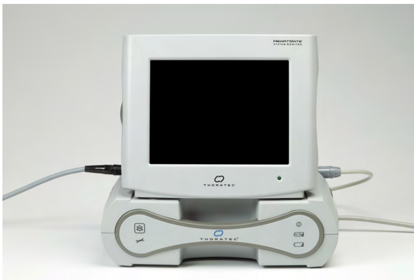
Rysunek 4.4 Monitor systemu zamontowany na module zasilania
