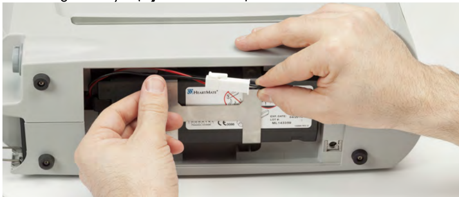
Rysunek 3.41 Delikatne zwinanie przewodów i złącza w górnej części baterii
