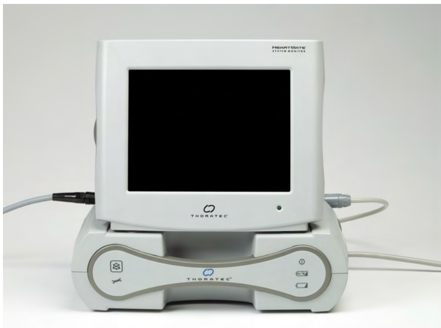
Rysunek 4.1 Monitor systemu zamontowany na module zasilania
