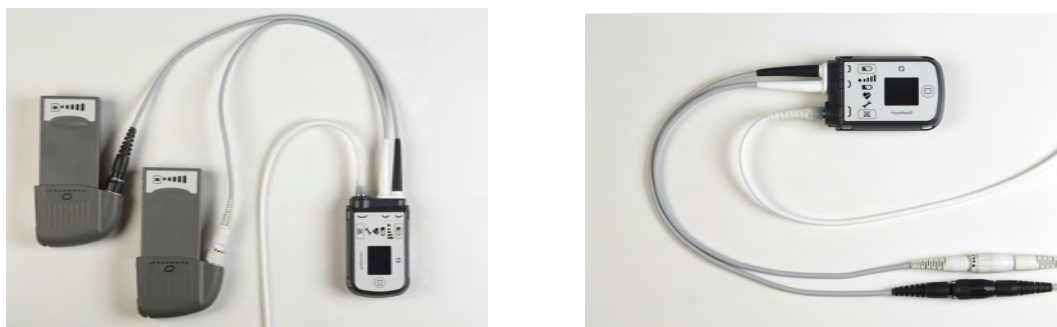
Rysunek 2.19 Urządzenie sterujące systemem w trybie pracy na zasilaniu z baterii (z lewej) oraz z modułu zasilania (z prawej)
