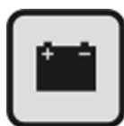
Rysunek 3.60 Symbol baterii znajdujący się na baterii (wskaźnik poziomu naładowania baterii)
