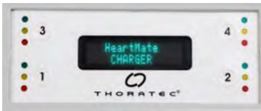
Rysunek 3.78 Kontrolki poziomu naładowania (zielona, żółta, czerwona) dla gniazd od 1 do 4
