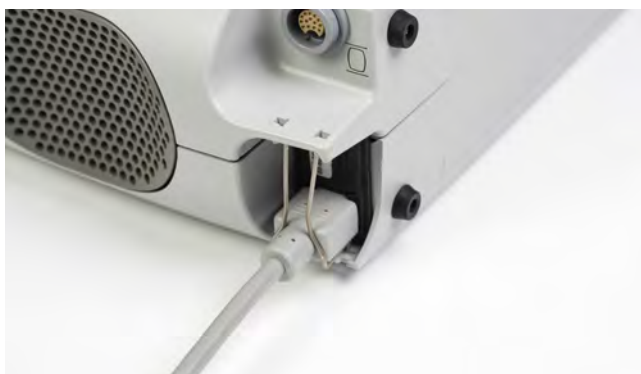
Rysunek 3.14 Wsuwanie końcówek zacisku do otworów
