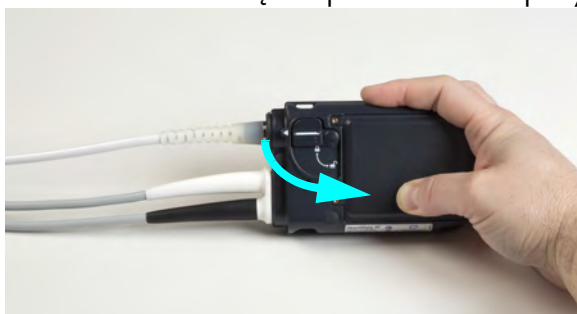
Rysunek 2.52 Odblokowywanie blokady bezpieczeństwa
