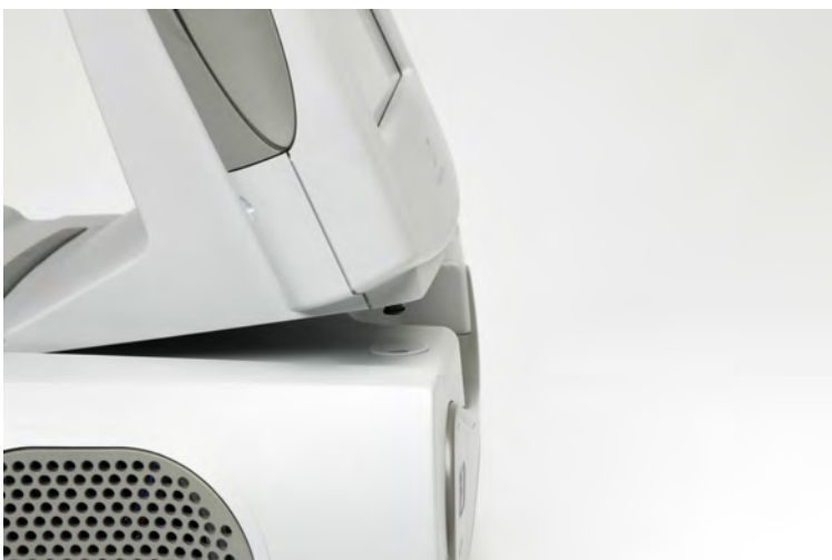
Rysunek 4.6 Zamontowanie nóżek monitora systemu w pierścieniach modułu zasilania
