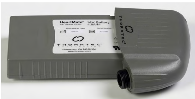
Rysunek 3.17 14-woltowa bateria litowo-jonowa HeartMate z zaciskami baterii 14-woltowej
