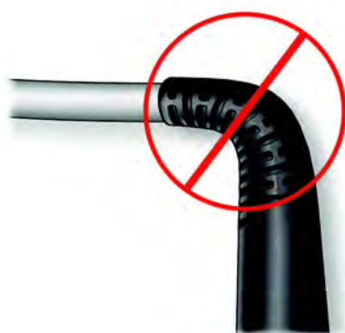
Rysunek 2.15 Nie zginać mocno przewodów zasilania
