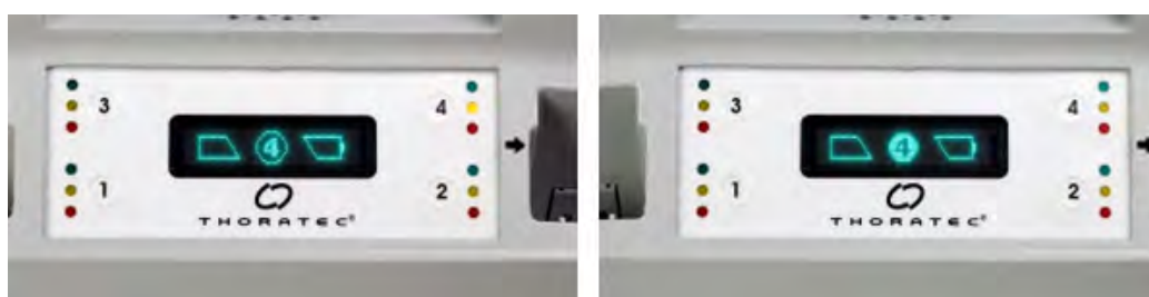
Rysunek 3.40 Wskazanie, że bateria w gnieździe nr 4 wymaga kalibracji
