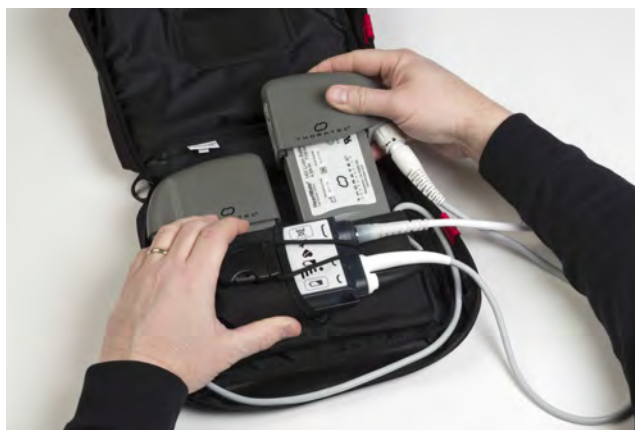
Rysunek 4.38 Wkładanie drugiej baterii
