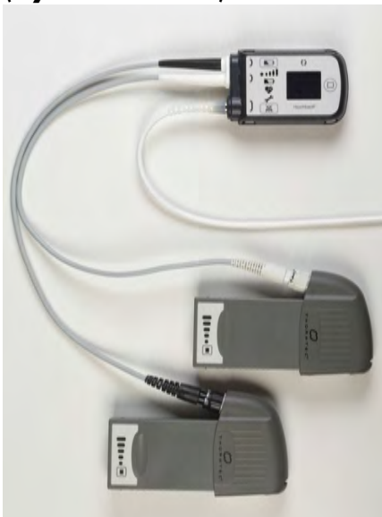
Rysunek 4.33 Przewody zasilania urządzenia sterującego i napęd nie są skręcone
