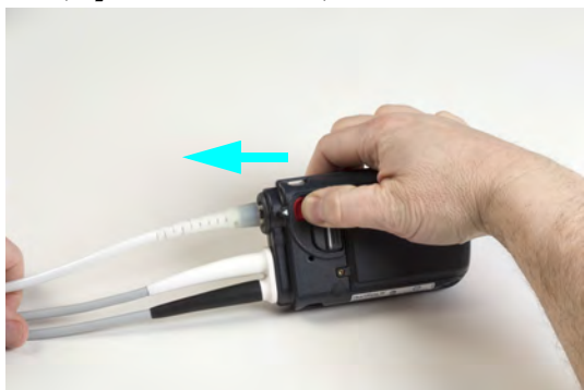
Rysunek 2.34 Odłączanie napędu
