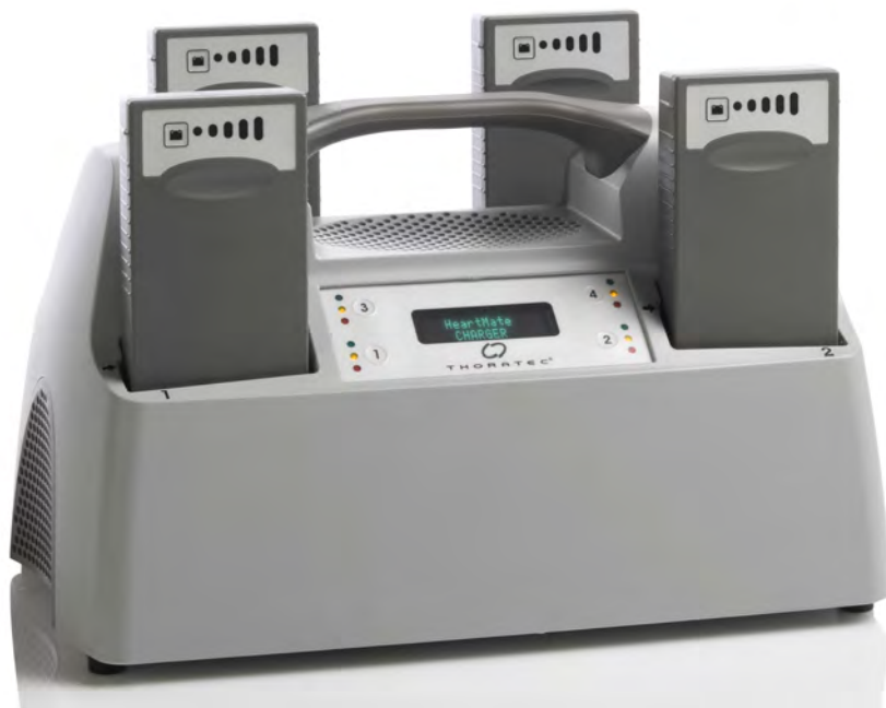
Rysunek 3.31 Baterie włożone do gniazd ładowarki baterii w celu naładowania
