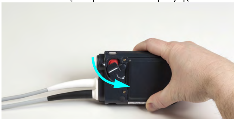
Rysunek 2.9 Odblokowywanie blokady bezpieczeństwa
