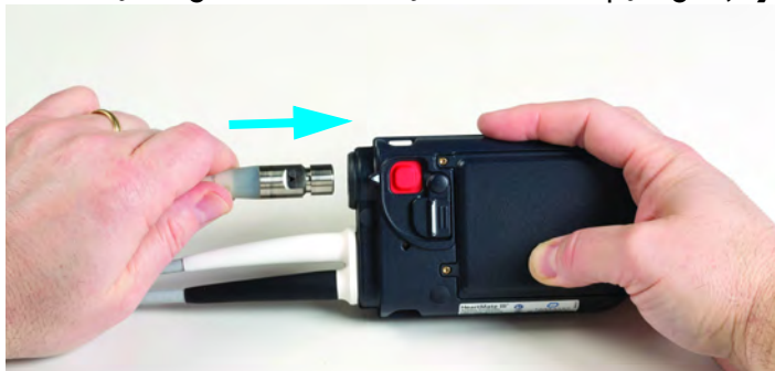
Rysunek 2.10 Ustawianie strzałek w jednej linii
