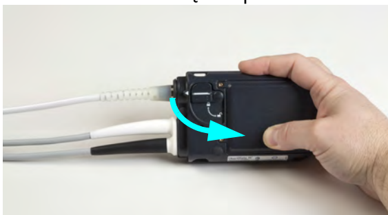
Rysunek 2.29 Odblokowywanie blokady bezpieczeństwa
