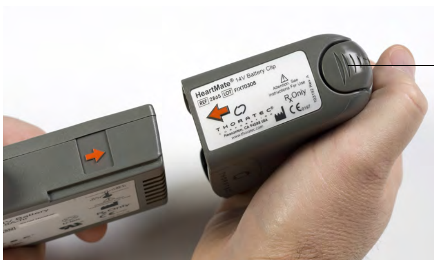
Rysunek 3.20 Naciśnięcie przycisku zwalniającego baterię i wyciągnięcie baterii
