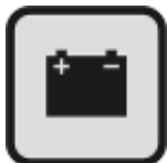
Rysunek 3.26 Symbol wskaźnika poziomu naładowania baterii na 14-woltowej baterii litowo-jonowej
