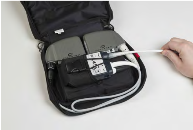
Rysunek 4.40 Zamykanie torby, napęd wyprowadzony między czerwonymi wypustkami
