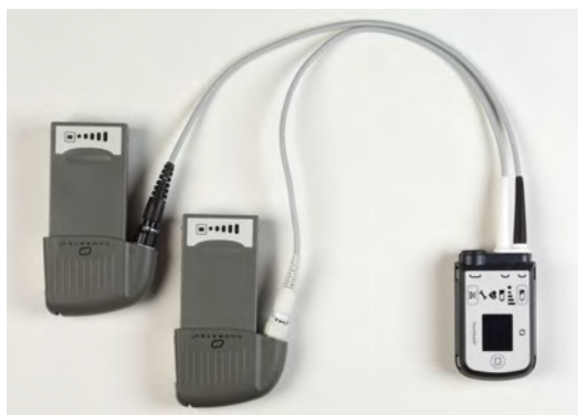
Rysunek 2.25 Urządzenie sterujące zasilane z zasilacza przenośnego (z lewej) oraz z baterii (z prawej)
