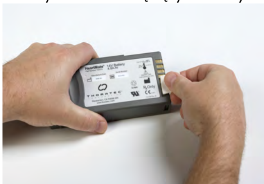
Rysunek 6.1 Czyszczenie styków baterii i zacisków baterii
