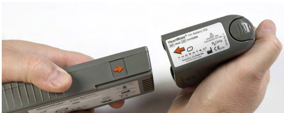
Rysunek 3.22 Umieszczanie baterii w zacisku baterii
