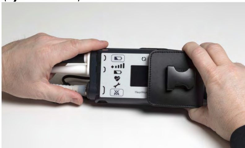
Rysunek 4.27 Wsuwanie urządzenia sterującego do mocowania do paska.
