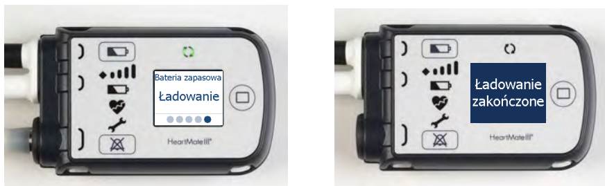
Rysunek 2.26 Komunikaty na urządzeniu sterującym: „ładowanie”, „ładowanie zakończone”
