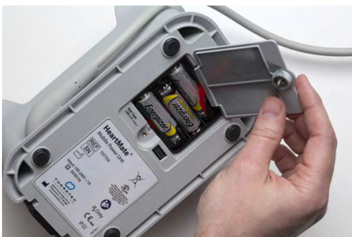
Rysunek 3.3 Zdejmowanie pokrywy kasety baterii
