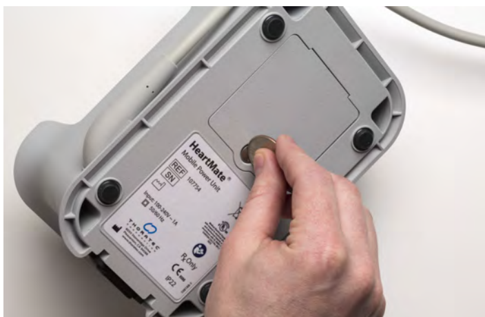
Rysunek 3.2 Luzowanie śruby
