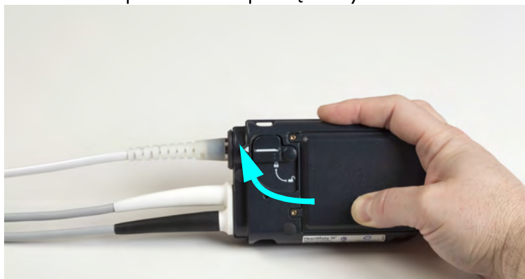
Rysunek 2.32 Zamykanie blokady bezpieczeństwa
