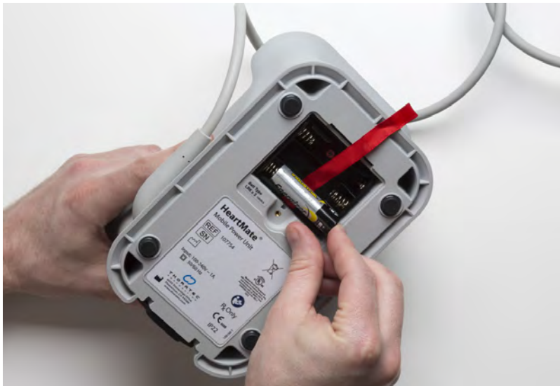
Rysunek 3.4 Wkładanie baterii AA
