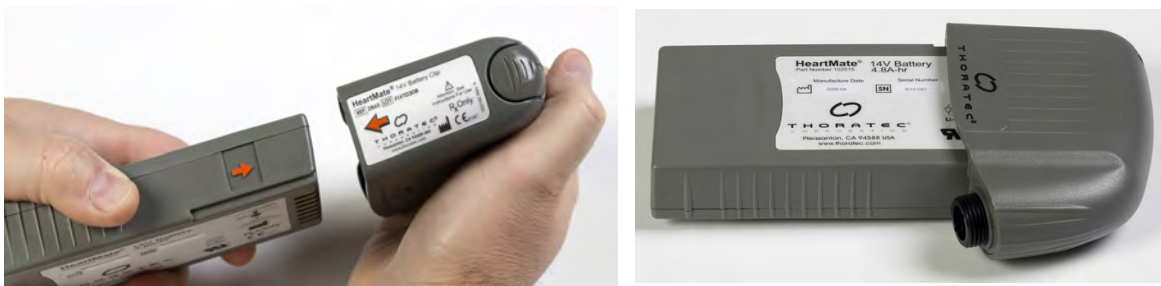
Rysunek 3.27 Ustawianie w jednej linii pomarańczowych strzałek i wkładanie baterii do zacisku baterii
