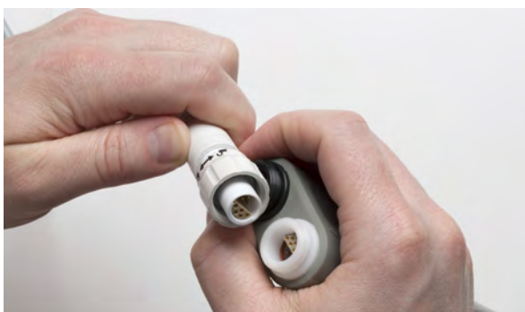
Rysunek 3.10 Dokładne dopasowanie złączy
