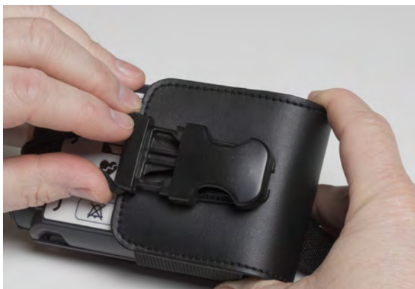
Rysunek 4.28 Umieszczanie paska między złączami
