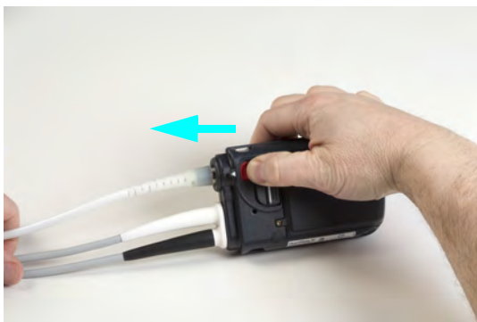
Rysunek 2.13 Odłączanie napędu
