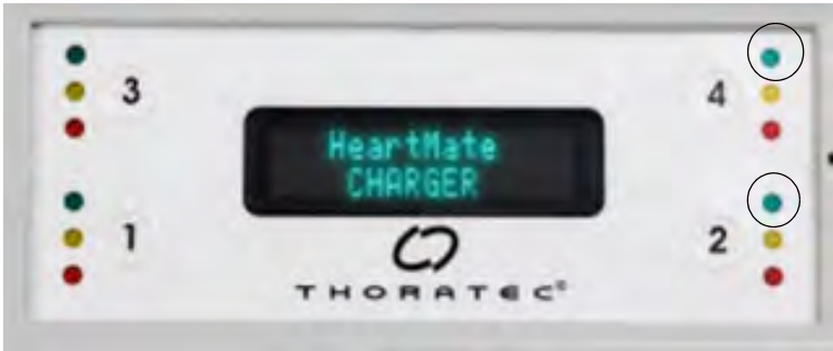
Rysunek 3.32 Zielona kontrolka oznacza naładowaną baterię
