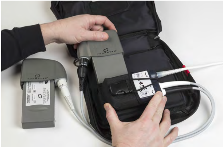
Rysunek 4.36 Wkładanie baterii i przyłączonego zacisk baterii do torby zbiorczej
