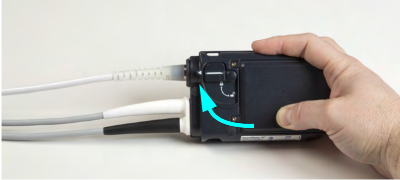
Rysunek 2.36 Zamykanie blokady bezpieczeństwa
