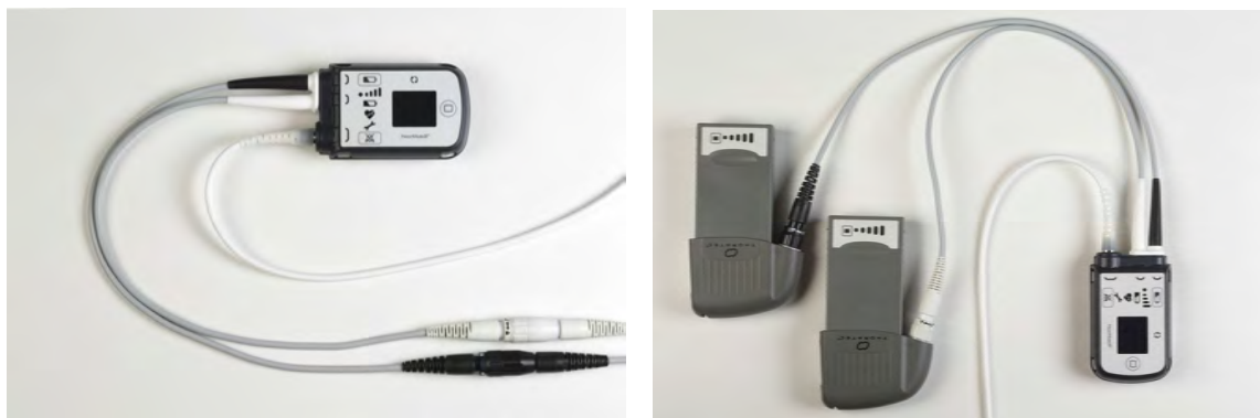
Rysunek 2.21 Urządzenie sterujące w trybie pracy podłączone do zasilacza przenośnego (z lewej) oraz do baterii (z prawej)
