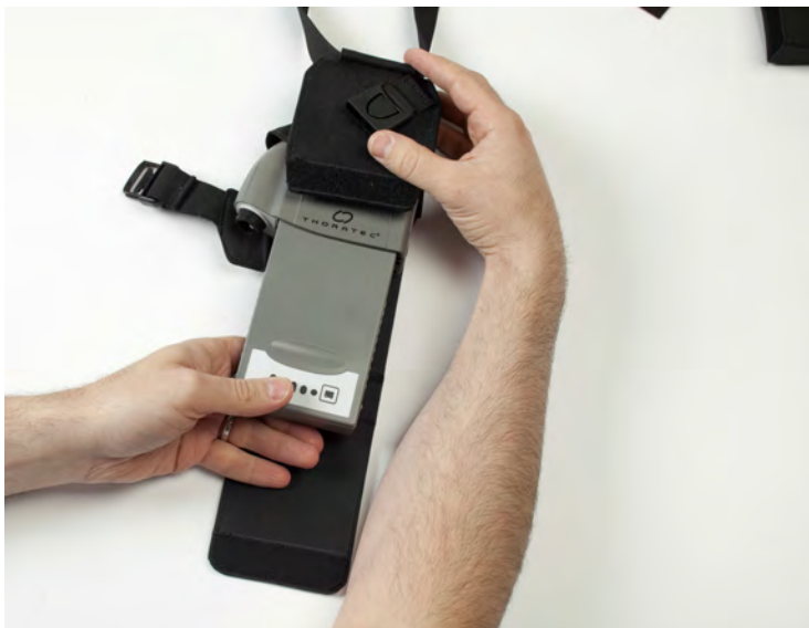
Rysunek 4.55 Wkładanie baterii i jej zacisk do futerału
