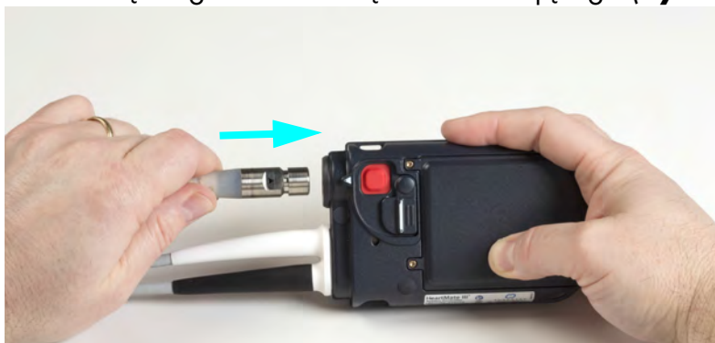
Rysunek 2.35 Ustawianie strzałek w jednej linii
