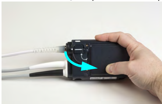
Rysunek 2.12 Odblokowywanie blokady bezpieczeństwa
