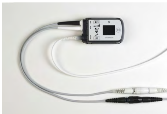
Rysunek 2.25 Urządzenie sterujące zasilane z zasilacza przenośnego (z lewej) oraz z baterii (z prawej)
