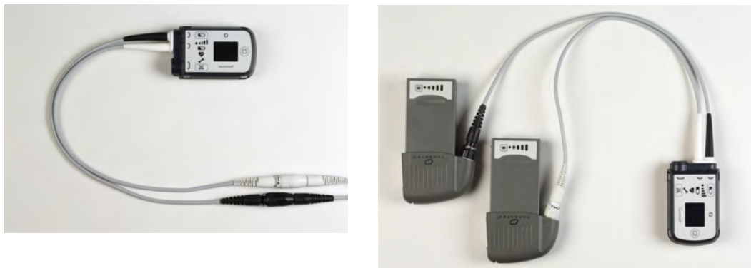
Rysunek 2.23 Urządzenie sterujące w trybie ładowania: Zasilanie z zasilacza przenośnego (z lewej), w pełni naładowane baterie (z prawej)
