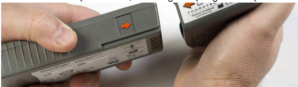
Rysunek 3.28 Umieszczanie baterii w zacisku baterii
