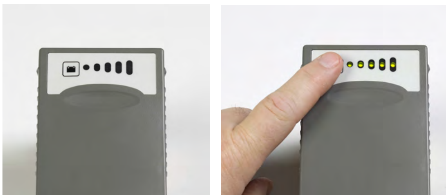
Rysunek 3.21 Naciśnięcie przycisku baterii w celu sprawdzenia poziomu naładowania baterii
