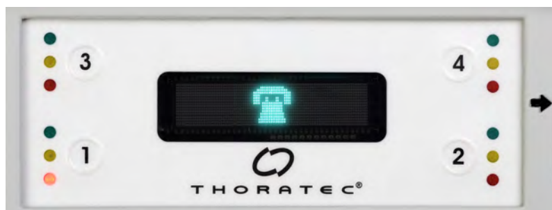
Rysunek 5.5 Symbol telefonu oraz czerwona kontrolka obok gniazda nr 1 wskazują, że ładowarka baterii wykryła problem
