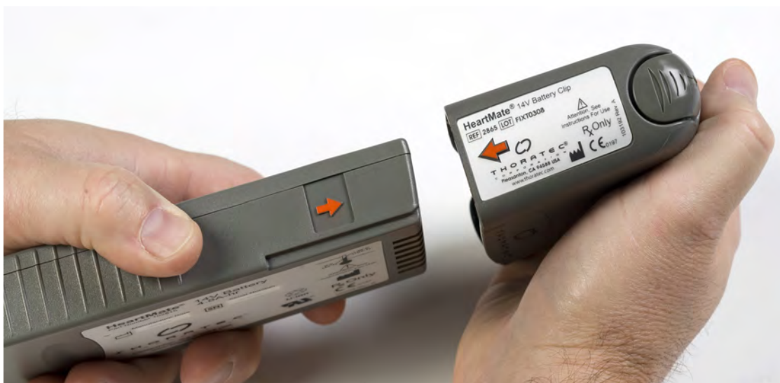
Rysunek 3.19 Ustawić strzałki w jednej linii
