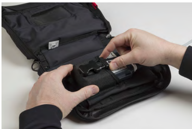
Rysunek 4.35 Pasek przełożony przez urządzenie sterujące oraz pomiędzy przewodami
