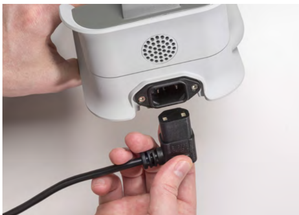
Rysunek 3.6 Podłączanie przewodu zasilania do zasilacza przenośnego
