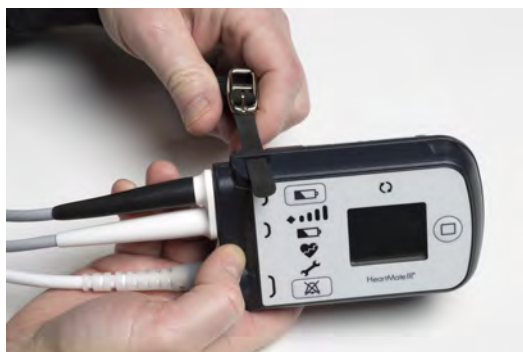
Rysunek 4.21 Wsuwanie taśmy przez punkt zaczepienia
