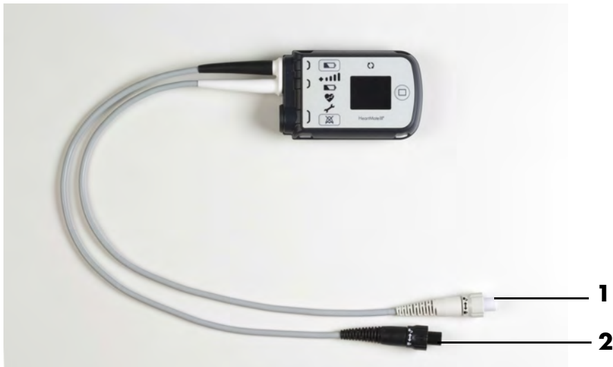
Rysunek 3.23 Przewód zasilania urządzenia sterującego z czarnym i białym złączem
