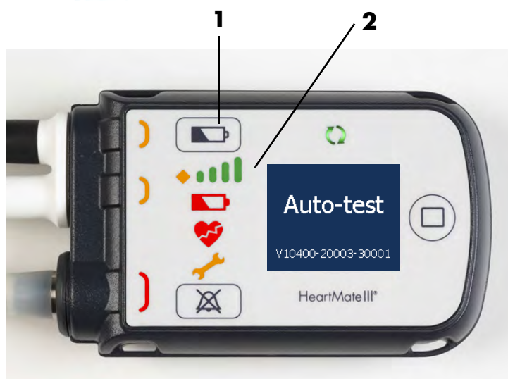
Rysunek 2.19 Wskaźnik poziomu naładowania baterii wskazujący, że bateria jest w pełni naładowana
