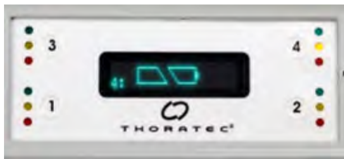
Rysunek 3.41 Bateria w gnieździe 4 podczas kalibracji
