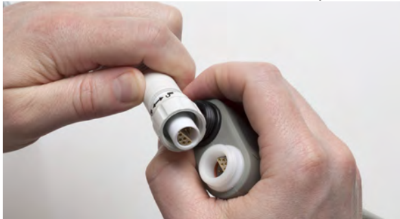
Rysunek 5.6 Wyrównanie złącz
